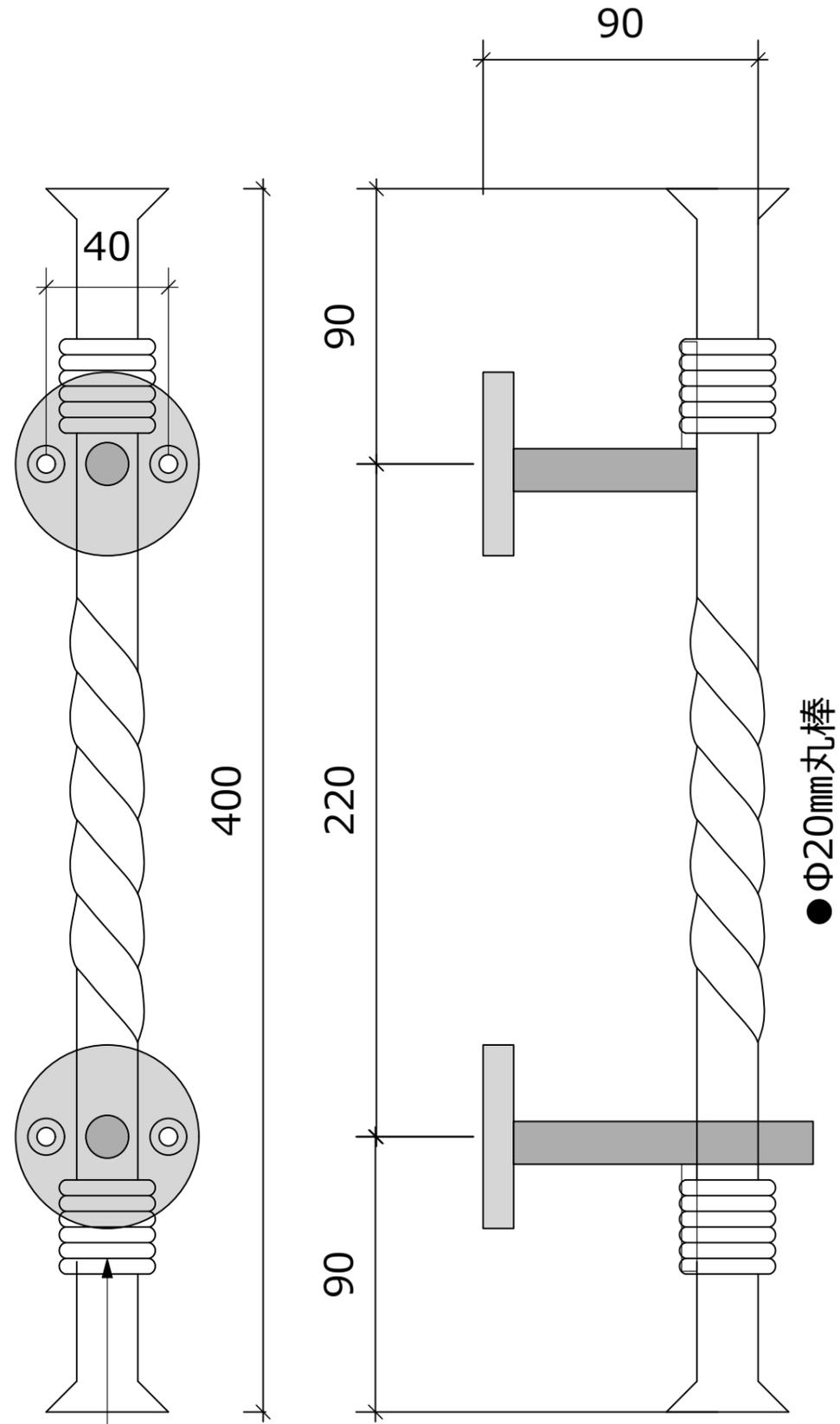
$\Phi 60\text{mm}$ 台座 (叩き仕上げ)
